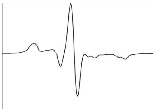
Abbildung 4.3. ESR-Spektrum aus 70 MD-Trajektorien der Spinsonde bei einer Temperatur von 270 K.
