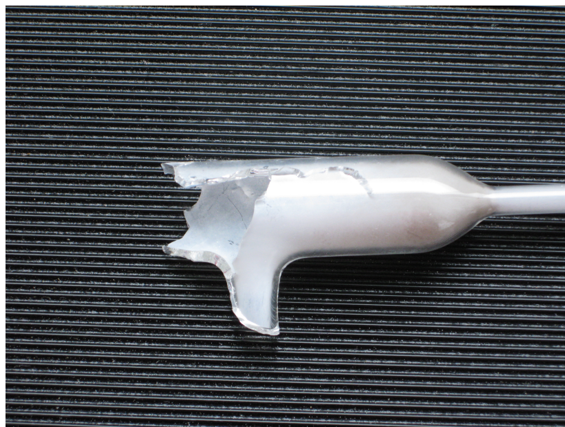
Abbildung 41: Bei der unkontrollierten Zersetzung von \text{HB}(\text{NiCl}_2) geborstenes Reaktionsrohr.
