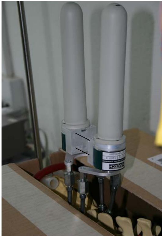
Abb. 53: Fixiertes Messgerät am Dummy mit triaxialen Kraftsensoren in beiden Hebelarmen. Hexapodisches Messsystem fehlt hier noch und ist graphisch angedeutet ( — ).
