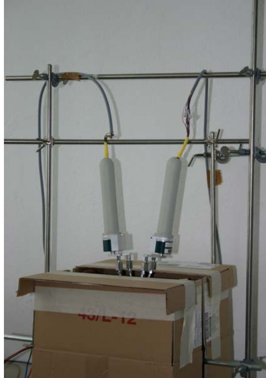
Abb. 53: Fixiertes Messgerät am Dummy mit triaxialen Kraftsensoren in beiden Hebelarmen. Hexapodisches Messsystem fehlt hier noch und ist graphisch angedeutet ( — ).
