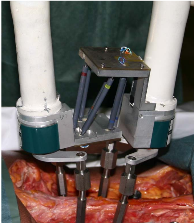
Abb. 51: Instabilitätsmessgerät mit hexapodischem Weg-Winkel-Messsystem
