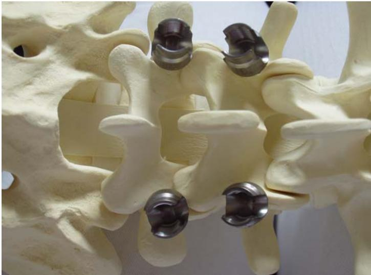
Abb. 35: Versuchsaufbau mit transpedikulär laufenden monoaxialen Pedikelschrauben am Dummy. Die Draufsicht verdeutlicht die unterschiedliche Richtung der gesetzten Pedikelschrauben.
