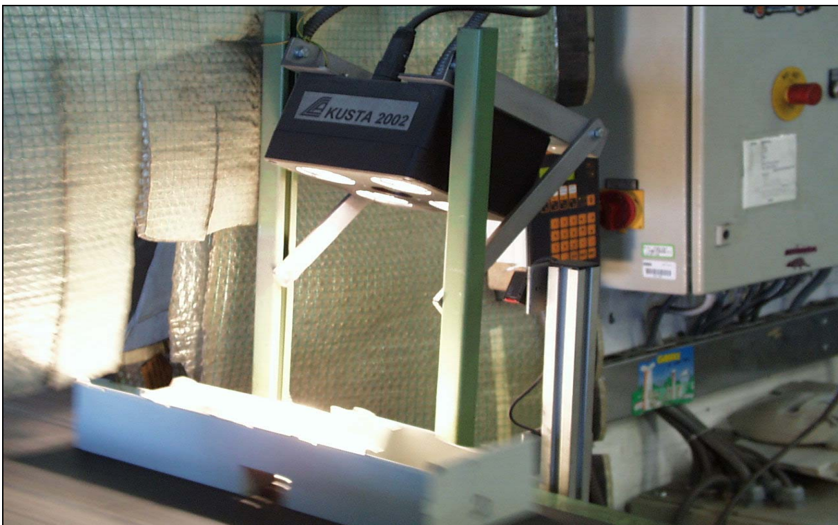
Abb. 5.1: Automatische Infrarot-Erkennung unterschiedlicher Kunststoffsorten aus Elektronikaltgeräten (Aufnahme Fujitsu Siemens Computers, Paderborn)
