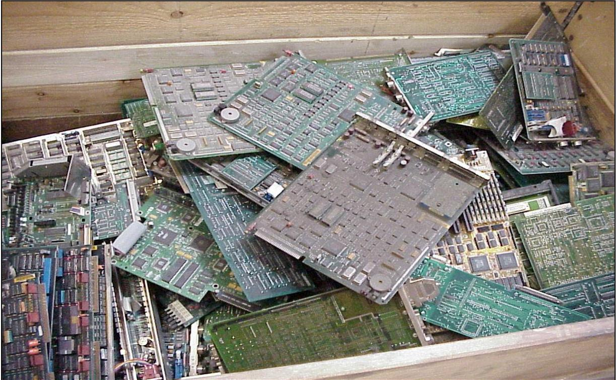
**Abb. 4.34: Demontierte Leiterplatten zur weiteren Behandlung im Wiedervermarktungs- und Recyclingwerk Paderborn (Foto: Fujitsu Siemens Computers)**
