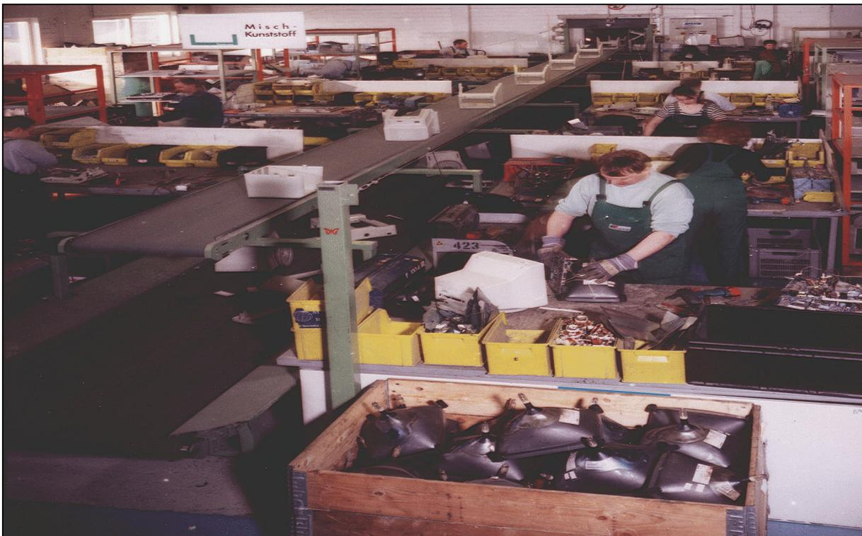
**Abb. 4.33: Demontage von Kleingeräten und Computerzubehör im Wiedervermarktungs- und Recyclingwerk Paderborn (Foto: Fujitsu Siemens Computers)**
