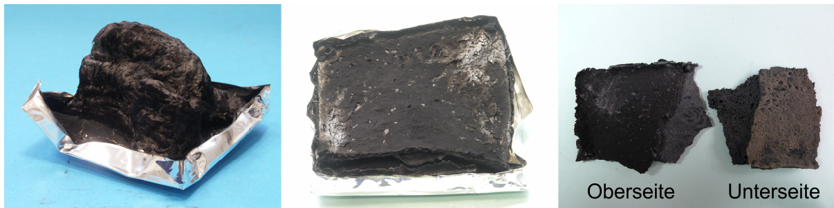
Abbildung 3.10 Brandrückstände von Cone Calorimeter Brandtests, links: PBT/AIPi-Et20, Mitte: PBT/AIPi-H+RXP20, rechts: Detailfoto PBT/AIPi-H+RXP20
