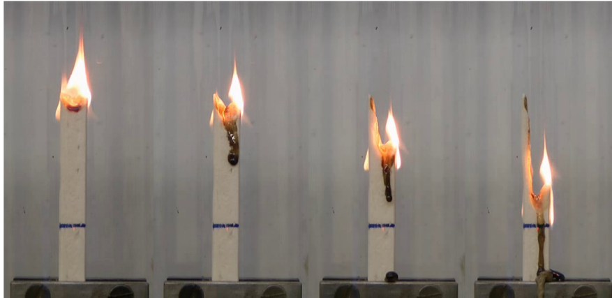
Abbildung 5.1 Fotos während eines LOI Tests von geschäumtem PBT bei einer Sauerstoffkonzentration von 25 %
