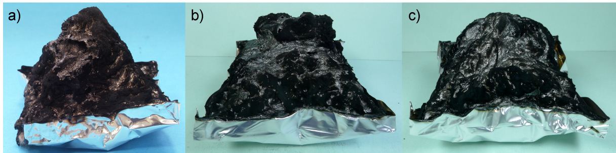
Abbildung 3.22 Brandrückstände von Cone Calorimeter Brandtests der phosphorhaltigen Polyester, a): PET-P-DOPO, b): PET-P-DPPO, c): PET-P-DPhPO
