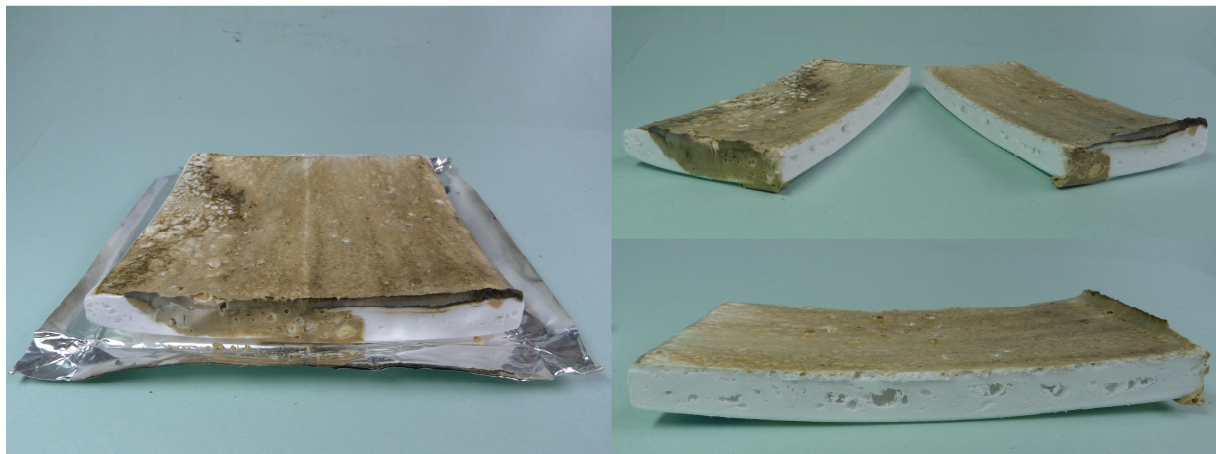
Abbildung 5.3 Prüfkörper von geschäumtem PBT nach einem direkt nach der Entzündung abgebrochenen und gelöschten Cone Calorimeter Test
