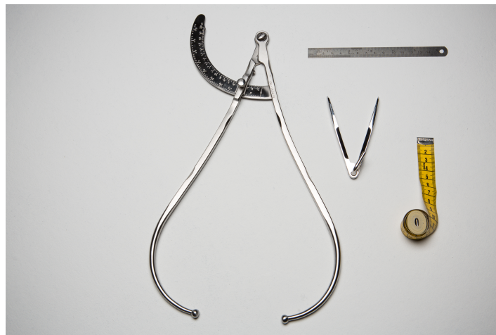
Abbildung 6: Verwendete anthropometrische Messinstrumente (von links nach rechts): großer Beckenzirkel mit integrierter Ablese- und Gradenskala, kleiner arretierbarer Messzirkel mit Lineal zum Ablesen der festgestellten Distanz und Maßband
