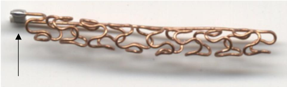
Abbildung 8. Ballon-expandierbarer Stent-Prototyp, bestehend aus einem gewickelten Kupferdraht und einem Kondensator (Pfeil).
