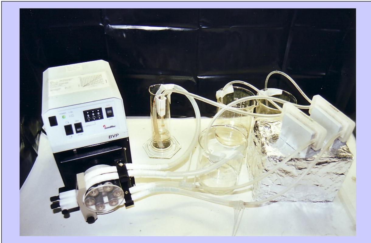
**Abbildung 10: Zwei-Kopf-Schlauchpumpensystem mit angeschlossenen Crossflowfilter-Einheiten zur Volumenreduktion der Proben**
