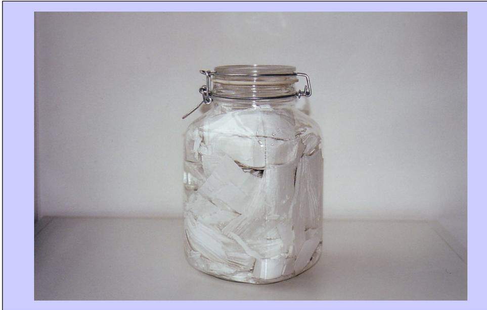
**Abbildung 7: Zerkleinerter Placebofilter mit Extraktionspuffer in Einweckglas**
