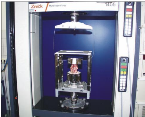
Abbildung 20: uniaxiale Prüfmaschine (Zwick 1455, Zwick GmbH, Ulm, Deutschland) mit eingespanntem Bewegungssegment C3/C4
