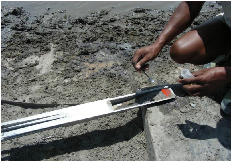
Abbildung 8: Probenentnahmegesetz für mit Wasser bedeckte Bodenschichten
