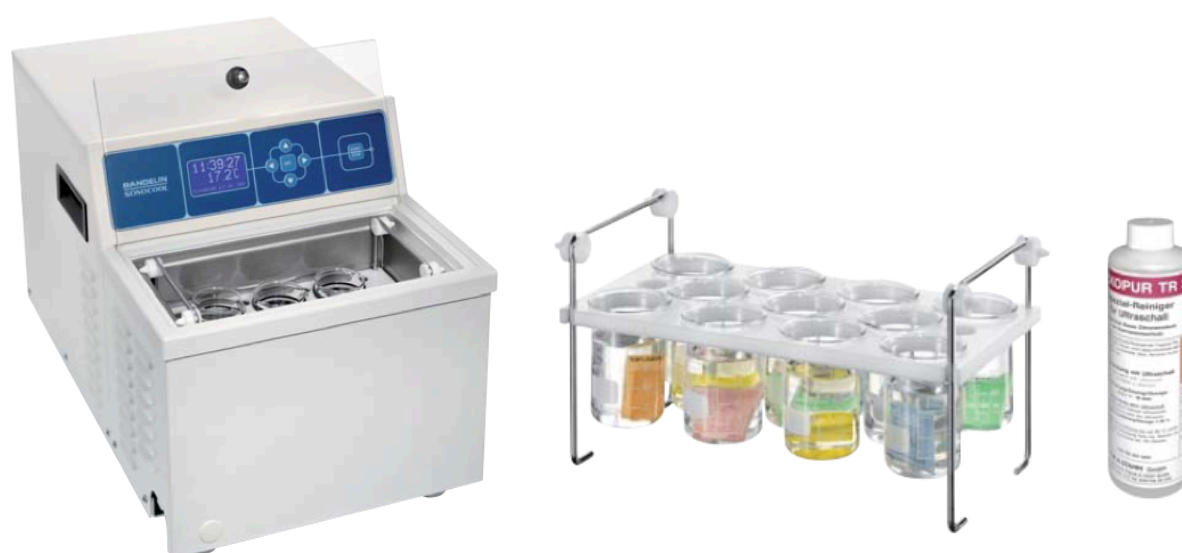
Abb. 5.2: Ultraschallgerät SONOCOOL , Probenhalter mit Einsatzgefäßen aus Glas, Kontaktflüssigkeit TICKOPUR TR 3 (aus: Datenblatt SONOCOOL , Bandelin electronic GmbH & Co. KG, 2014)
