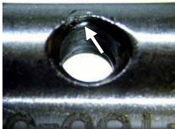
Abb. 27: Beschädigtes Schraubenloch (weißer Pfeil) des Verriegelungsnagels nach einmaliger Belastung mit einem Drehmoment von \pm 5 Nm.
