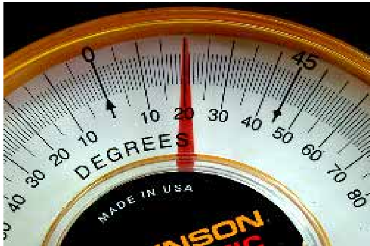
Abb. 25a: Die initiale Rotationsinstabilität eines VN-Fraktur-Modell-Konstruktes betrug 20^\circ vor jeglicher Belastung.
