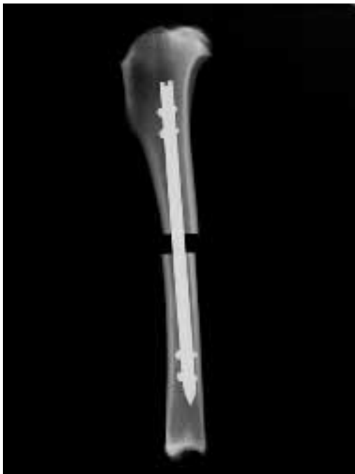
Abb. 15: Röntgenbilder (links: medio-lateral, rechts: anterior-posterior) eines zur Einbettung vorbereiteten Verriegelungsnagel-Fraktur-Modell-Konstruktes.
