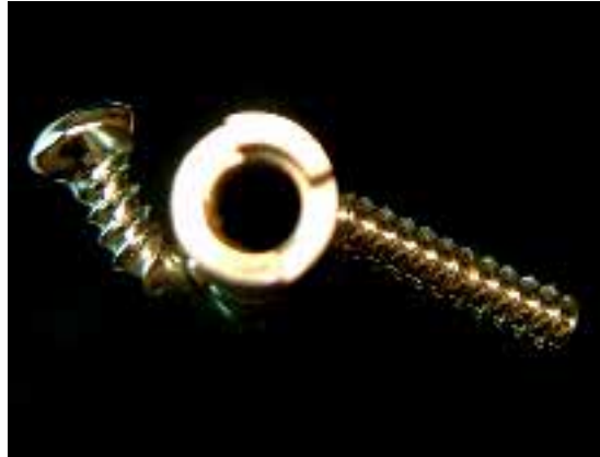
Abb. 29: Verformung der distalen 2,7 mm-Verriegelungsschrauben nach dem Test auf Torsionsfestigkeit.
