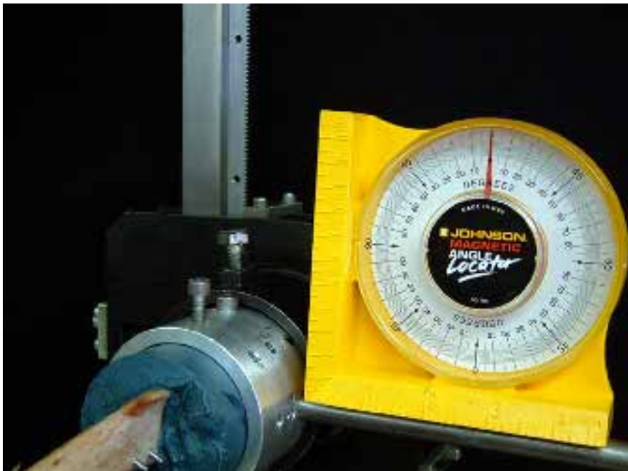
Abb. 24: Meßvorrichtung zur Datenüberprüfung der VN-Meßwerte in Torsion.
