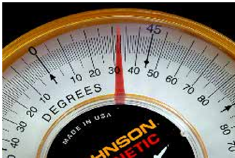
Abb. 25b: Die Rotationsinstabilität eines VN-Fraktur-Modell-Konstruktes nach nur einem Zyklus mit einem Drehmoment von 5 Nm betrug ca. 33^\circ .
