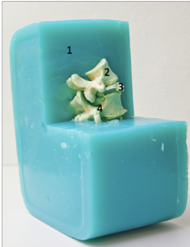
Abb. 10: Agarose-Wirbelsäulen-Modell: Agarose-Block (1), Wirbelkörper aus Hartplastik (2), Bandscheibe aus Agarose mit Latexüberzug (3) und Plastikkatheter als Nervenwurzel (4) [Eigenerfertigung].
