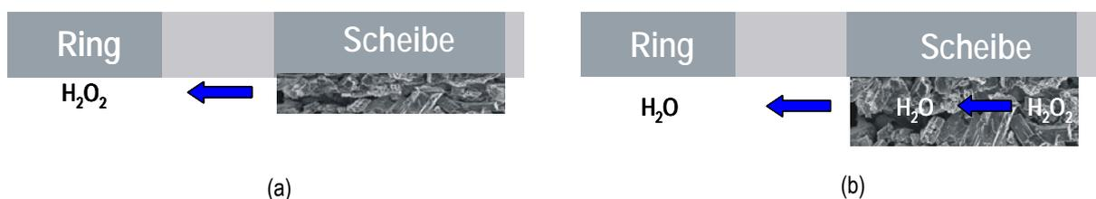
Abbildung 3-11. (a) Schema des Transfers von  $H_2O_2$  von Scheibe zu Ring bei einer geringen Beladung der Scheibe (Transfer ohne Behinderung) und (b) bei einer hohen Beladung der Scheibe (lange Diffusionswege und Zerfall von  $H_2O_2$  (Senkenreaktion))
