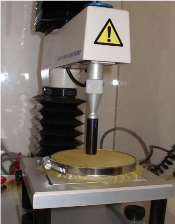
*Abb. 20: Bestimmung der Härte der Kollagensubstituten mit dem Texture Analyzer*
