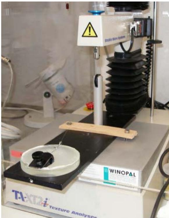
Abb. 21: Bestimmung der Membran-Untergrundgel-Haftung der Kollagensubstituten mit dem Texture Analyser
