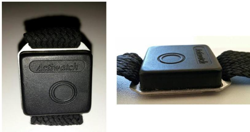
*Abbildung 5: Fotografien eines verwendeten Aktimeters von oben und von der Seite*
