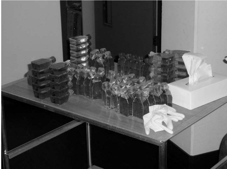
**Abb. 6: Kulturflaschen für das Experiment 1: Hier sind die für den Versuch vorbereiteten Proben zu sehen. Die Kulturflaschen sind bis zum Rand mit Medium gefüllt, um die Scherkräfte so gering wie möglich zu halten.**
