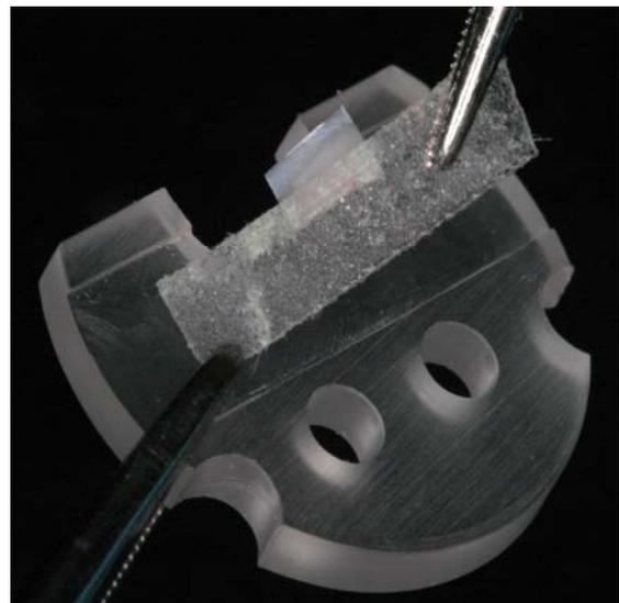
**Abb. 5:** TMR-Probenhalter mit Dünnschliff
