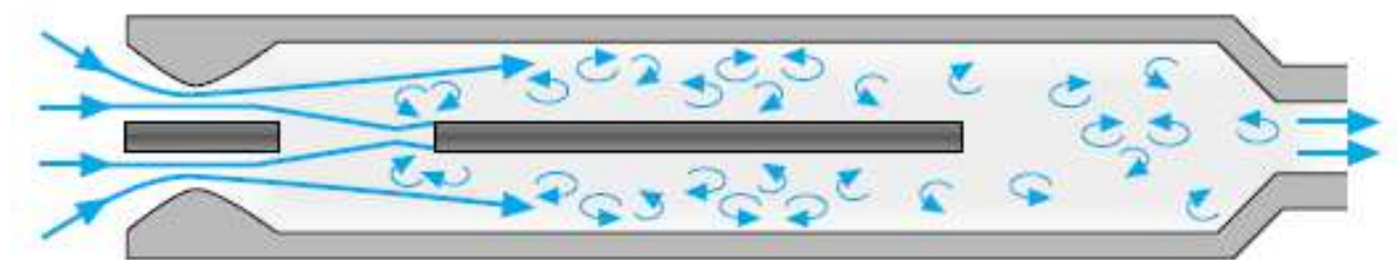
Abbildung 6: Strömungsverhältnisse bei großen Perforationen. Gerade Pfeile markieren laminare Strombahnen – gekrümmte Pfeile markieren turbulente Strombahnen [14]
