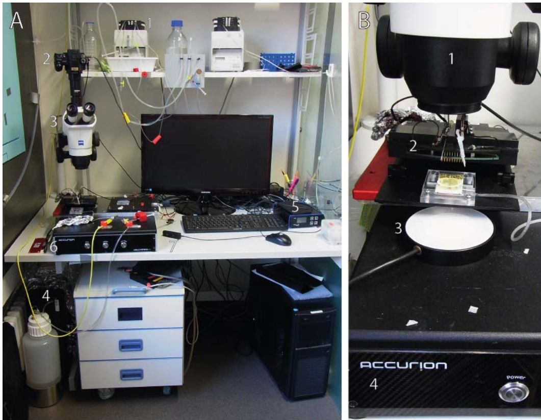
Abbildung 10 MEA-Aufbau A Übersicht des MEA-Aufbaus: 1. Minipulse 3 2. Alpha 37 3. Stemi 2000C 4. CVP 5. TC02 6. Halcionics_i4 7 Fernauslöser für die Kamera B Nahaufnahme des MEAs: 1. Stemi 2000C 2. USB-MEA32-STIM4 3. EasyLED Backlights 4. Halcionics_i4
