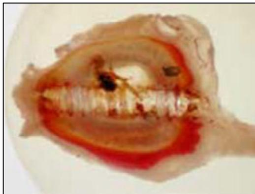
**Abb. 10:** 4 mm dicke Knochenscheibe mit Schraubenkanal in Kunststoff eingebettet
