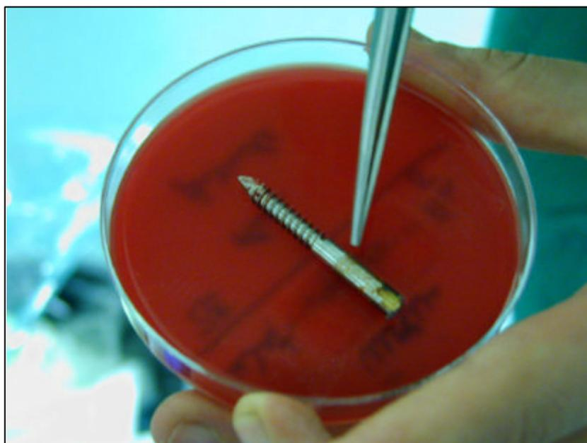
**Abb. 14:** Abrollen der herausgedrehten und gekürzten Schraube auf Blutagarplatte
