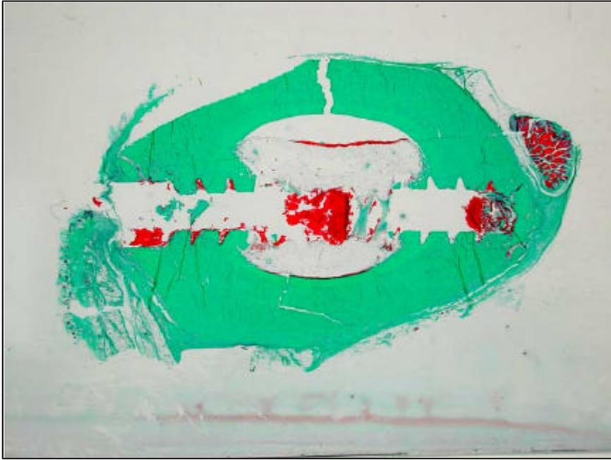
**Abb. 12:** Trichrom-Färbung nach Masson-Goldner eines in Methylmethacrylat eingebetteten Knochenschnittes mit Bohrkanal
