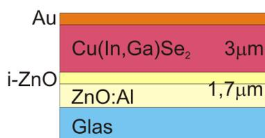
Abbildung 1.3: Vereinfachter Schichtstapel einer  $\text{Cu}(\text{In,Ga})\text{Se}_2$ -Superstratsolarzelle nach Terheggen et al. [11].
