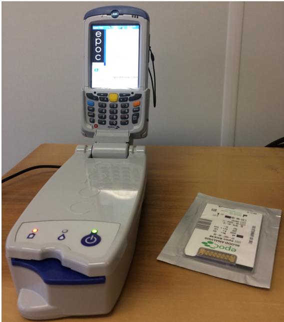
**Abb. 4:** Das verwendete mobile Blutgasmessgerät epoc® Reader and epoc® Host2 der Firma Alere mit daneben liegender Testkarte zur Laktat-, und Glukosebestimmung.
