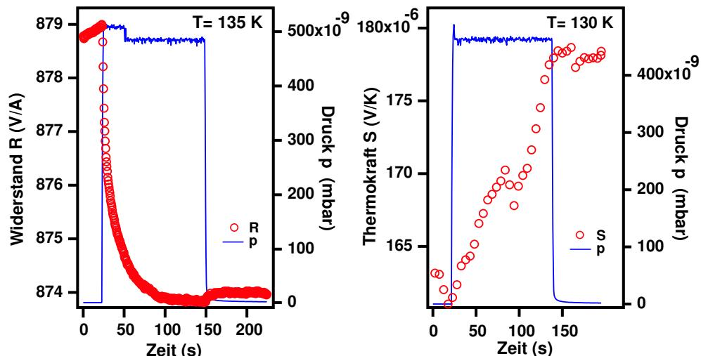
Abbildung 7.8:  $R$  (links) und  $S$  (rechts) während der Dosierung von  $C_6H_6$ . Der Benzolpartialdruck wurde über den Kammer-Hintergrunddruck gemessen.
