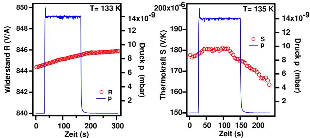
Abbildung 7.7: Widerstand (links) und Thermokraft (rechts) bei  $SF_6$ -Dosierung. Der angegebene Druck ist der Hintergrunddruck in der UHV-Kammer. Die mittlere Probentemperatur betrug ungefähr  $135\text{ K}$ .
