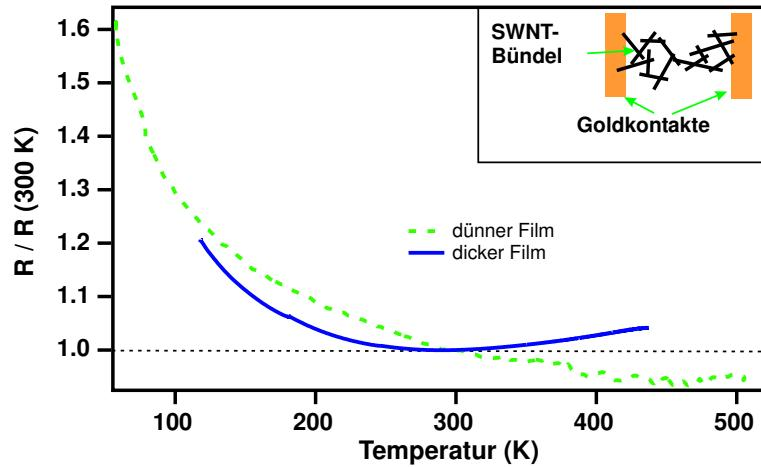
Abbildung 7.1: Temperaturabhängigkeit des Widerstandes, der auf den Widerstand bei  $300 \text{ K}$  normiert ist, für zwei unterschiedlich dicke Filme. Die Messung wurde im Ultra-Hochvakuum (UHV) durchgeführt. Im Einsatz ist eine schematische Darstellung eines Films aus SWNT-Bündeln dargestellt.
