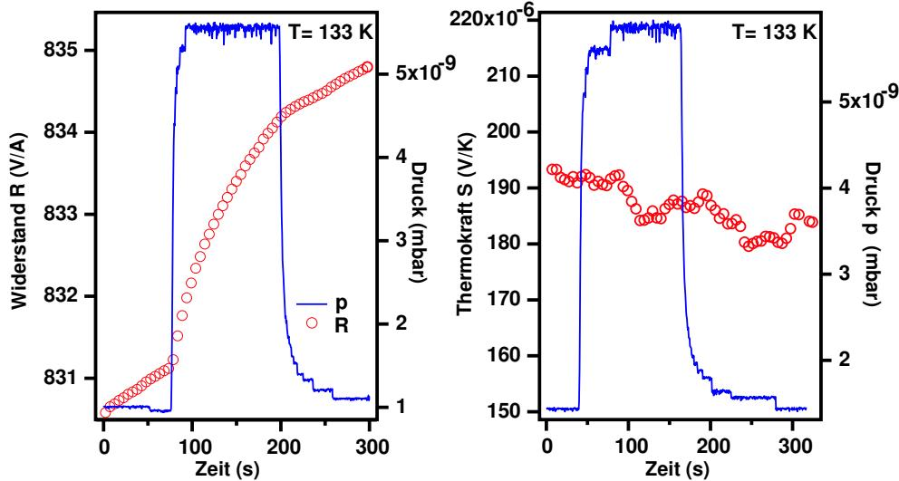
Abbildung 7.9: Widerstand (links) und Thermokraft (rechts) während Dosieren von  $H_2O$ . Der Druck ist der Hintergrunddruck in der UHV-Kammer.
