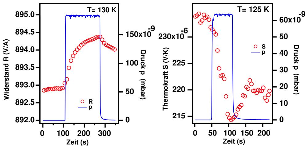
Abbildung 7.11: Widerstand (links) und Thermokraft (rechts) bei Dosieren von  $NH_3$ . Der  $NH_3$ -Partialdruck wurde über den Hintergrunddruck in der UHV-Kammer bestimmt.
