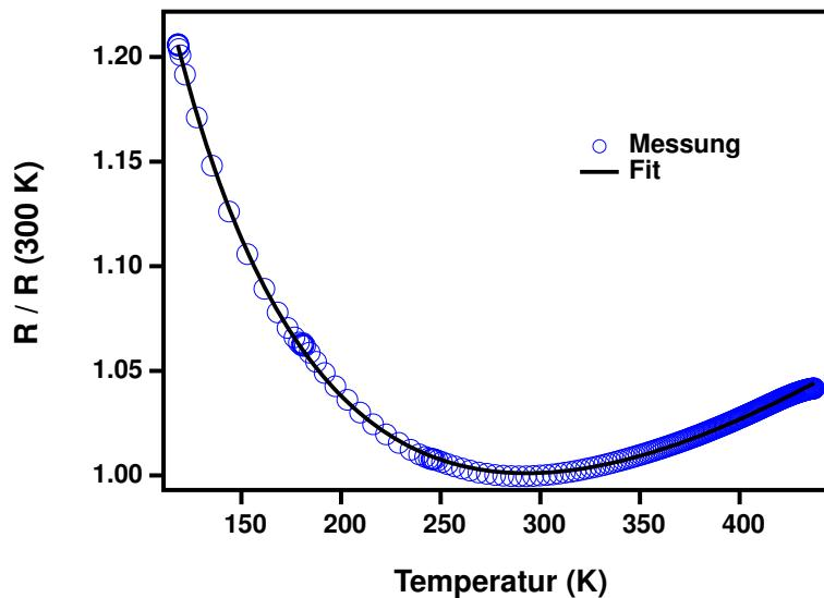
Abbildung 7.2: Temperaturabhängiger Widerstand des dickeren Films mit Gleichung (7.5) gefittet.
