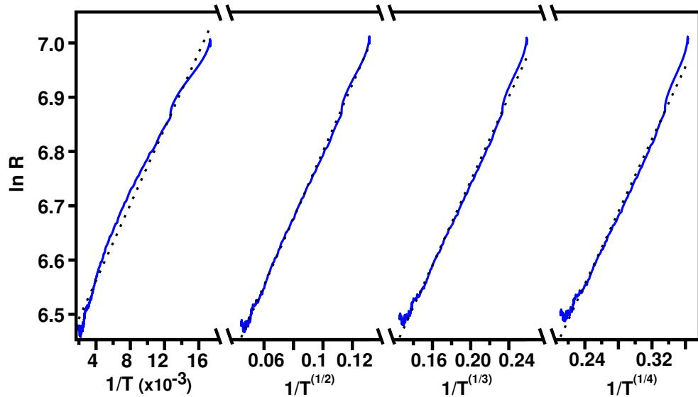
Abbildung 7.3: *Variable Range Hopping* (VRH) über Bündel-Bündel-Kontaktstellen oder intrinsischen Röhrendefekten in verschiedenen Dimensionen  $d$ . Die gestrichelten Linien sind zur Orientierung. Die Auftragungen entsprechen dem Modell für verschiedene Dimensionen  $d$ , das heißt, den entsprechenden gebrochenen Potenzen der inversen Temperatur  $1/T^{(1+d)}$ . Außerdem ist noch das  $1/T$ -Verhalten gezeigt.
