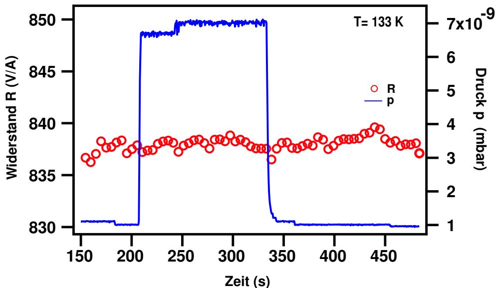
Abbildung 7.5: Elektrischer Widerstand des SWNT-Films bei  $O_2$ -Dosierung. Der angegebene Druck ist der  $O_2$ -Hintergrunddruck in der UHV-Kammer. Die durchgezogenen Linien beschreiben den Druckverlauf in der UHV-Kammer bei Dosieren, die gepunktete Linie (offene Kreise) den elektrischen Widerstand.
