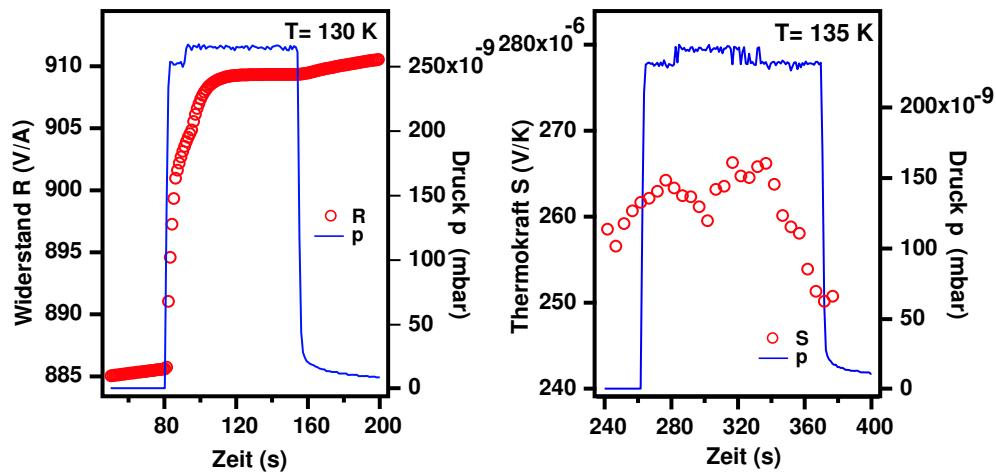
Abbildung 7.10: Widerstand (links) und Thermokraft (rechts) beim Dosieren von  $CH_4O$ .
