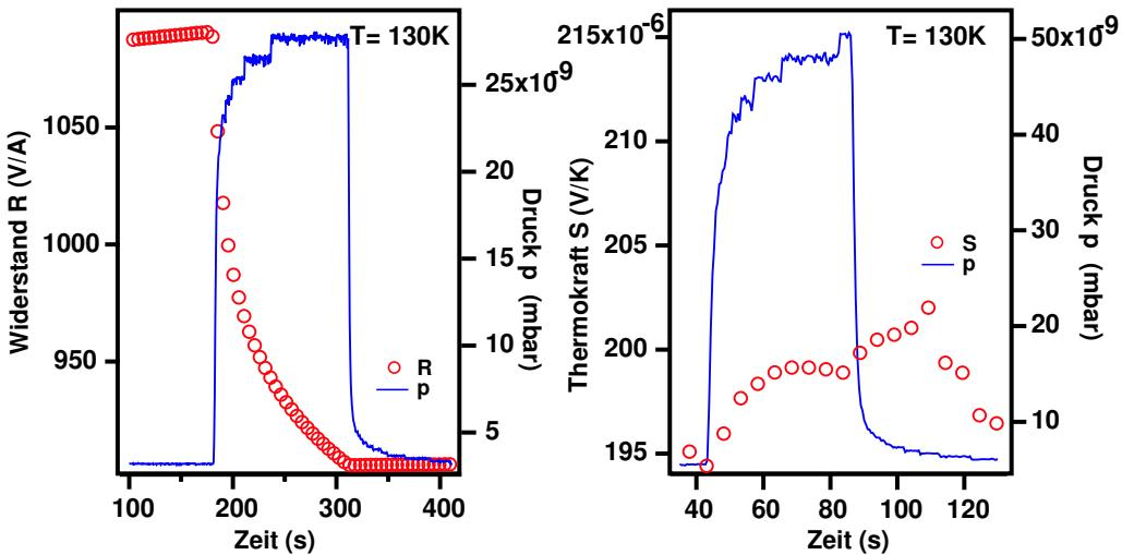
Abbildung 7.6: Widerstand (links) und Thermokraft (rechts) des SWNT-Materials bei  $NO_2$ -Dosierung.  $p$  ist der Hintergrunddruck in der UHV-Kammer. Die Messungen wurden bei  $130\text{ K}$  durchgeführt.
