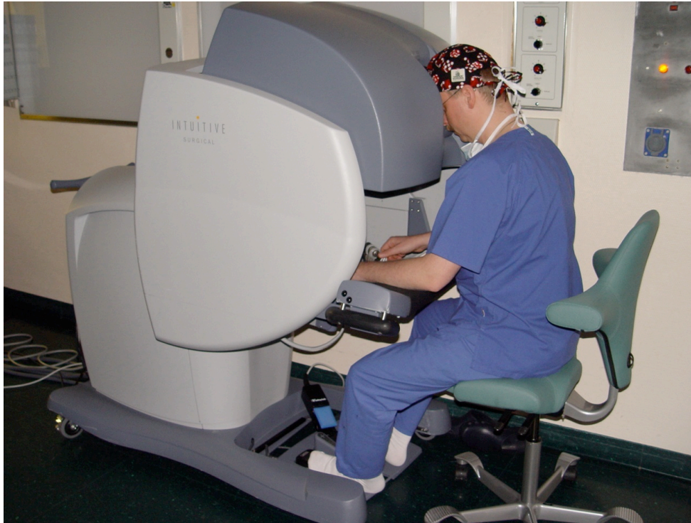
Abbildung 3: Die da Vinci® Operationstechnik; der Operateur sitzt an einer Konsole und steuert über zwei Joystick-Hebel und zwei Fusspedale die Arme und die Arbeitswerkzeuge des Operationsroboters (Foto: Charité Universitätsmedizin, Berlin).
