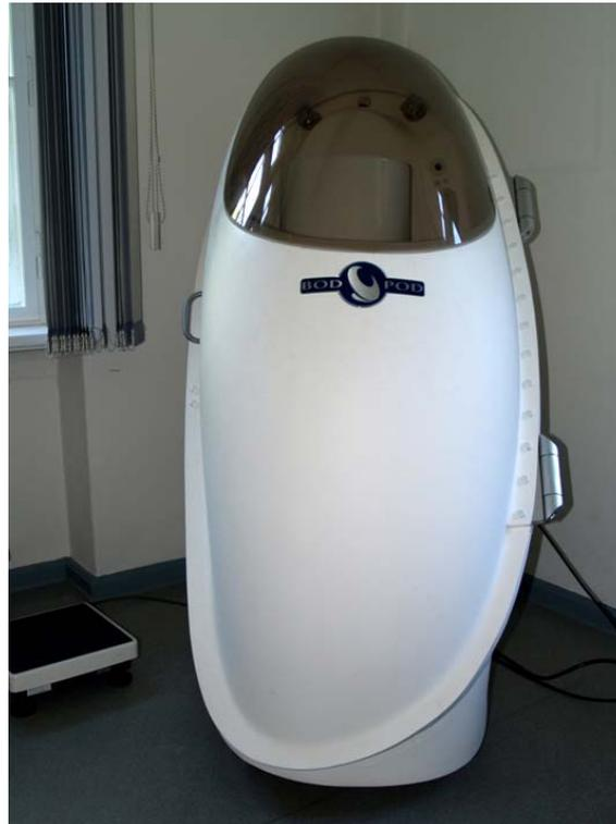
**Abbildung 8: BodPod® zur Messung der Körperzusammensetzung**
