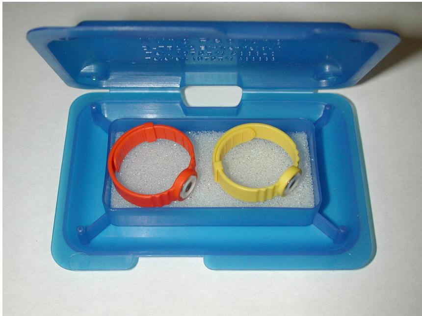
**Abb. 28 Beta-Fingerringdosimeter Typ HARSHAW BTKD 2001- II**
