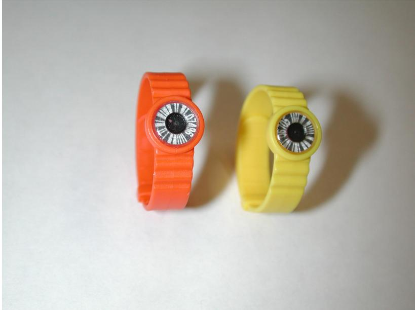
**Abb. 27 Beta-Fingerringdosimeter Typ HARSHAW BTKD 2001**
