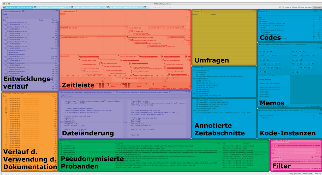
ABBILDUNG 3.22: Dieser Screenshot von APIUA in der Perspektive für offenes Kodieren zeigt die von den verschiedenen Plugins der Schicht 3 beigesteuerten Eclipse-Views. V.l.n.r.: Violett: Diff-Plugin; Rot: Timeline-Plugin; Gelb: Stats-Plugin; Blau: GTM-Plugin; Orange: Doclog-Plugin; Grün: Entity-Plugin; Pink: Core-Plugin
