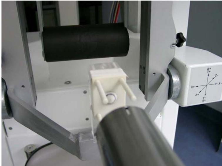
**Abbildung 41: Am Behandlungsstuhl fixiertes Kunststoffgehäuse mit Phantom.**
