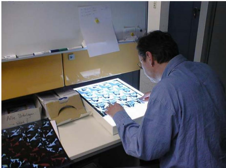
**Abbildung 8: Clipdistanzmessung am Lichtkasten.**
