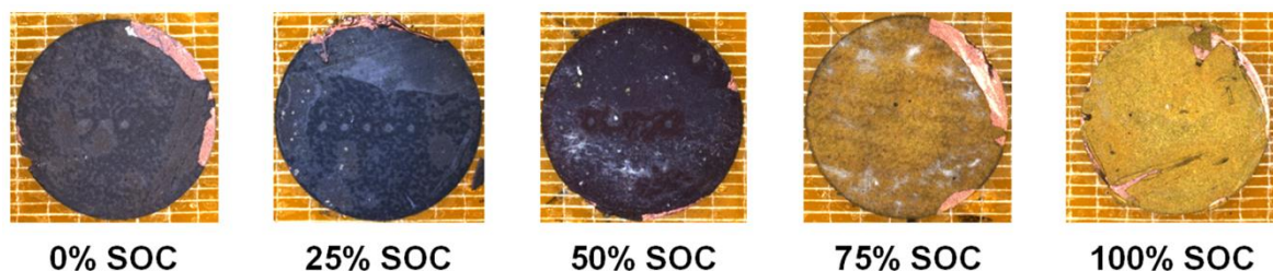
Abb. 19: Lichtmikroskopische Aufnahmen der Graphitanoden, die in Halbzellversuchen auf verschiedene Ladezustände eingestellt wurden
