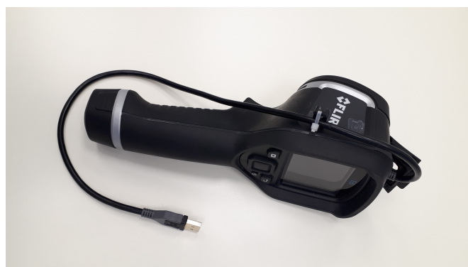
Abbildung 10) FLIR E6 Wärmebildkamera zur infrarotthermografischen Messung von Oberflächentemperaturen
