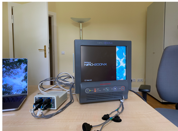
Abbildung 11) NIRS-Gerät NIRO 200 von Hamamatsu und Auswerteeinheit zur nahinfrarotspektroskopischen Beurteilung von Chromophor-Konzentrationsveränderungen im Gewebe. (Chromophor = Farbgebendes Atom/Molekül wie in Hämoglobin oder Myoglobin)
