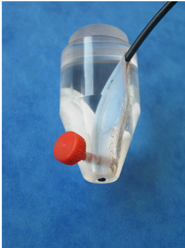
Abbildung 2.4: In den Objektivrevolver einschraubbare Halterung für das Lichtleiterkabel
