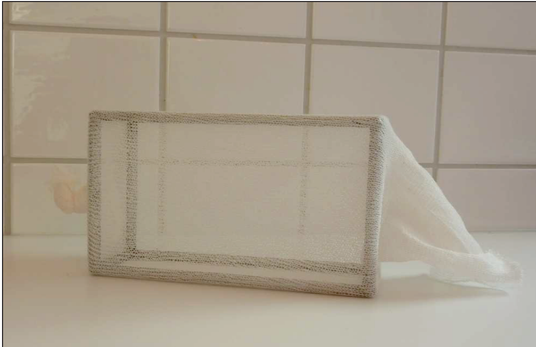
Abbildung 3: Drahtkäfige aus V2A-Metalldraht überspannt mit tg ® -Schlauchverband zur Durchführung des Petrischalen-Tests im Rahmen der Feldstudie zwischen Juni und September 2013 in Schleswig-Holstein.
