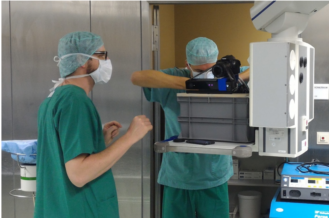
Abb. 29, Installation eines Aufnahmemoduls, bestehend aus Tiefensensor und Videokamera, Charité - Universitätsmedizin Berlin.
