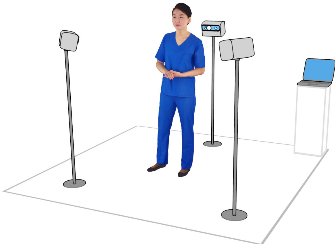
Abb. 31: Schematische Anordnung der volumetrischen Szene mit drei Aufnahme-Modulen und Server.
