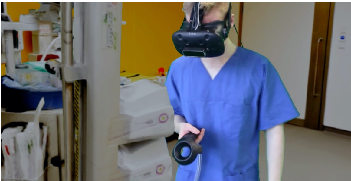
Abb. 1, a) Mixed reality Brille HoloLens mit transparentem Display, b) Virtual reality Brille Vive mit opakem Display.
