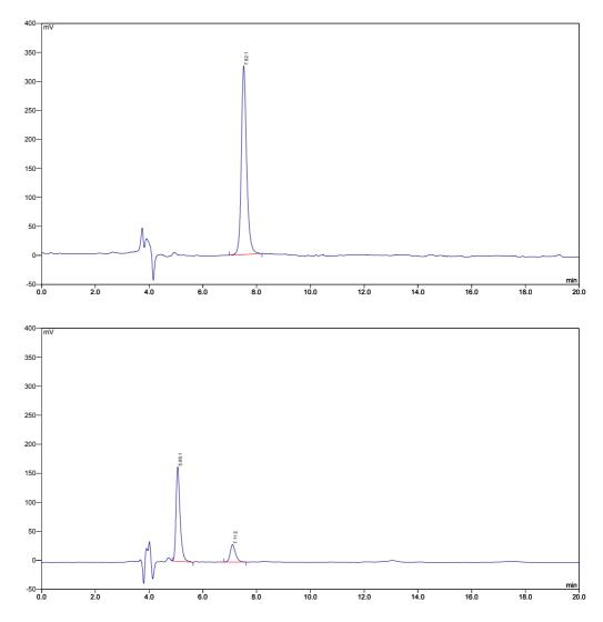
**Abb. 3.6:** Chromatogramme von **70**, gelöst in PBS, direkt nach dem Verdünnen (oben) und nach 56 h bei 37 °C.
