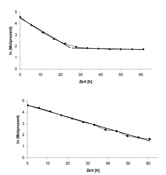
Abb. 3.10: Semilogarithmische Darstellung des Hydrolyseverlauf von 70 (oben) und 72 (unten) in PBS.
