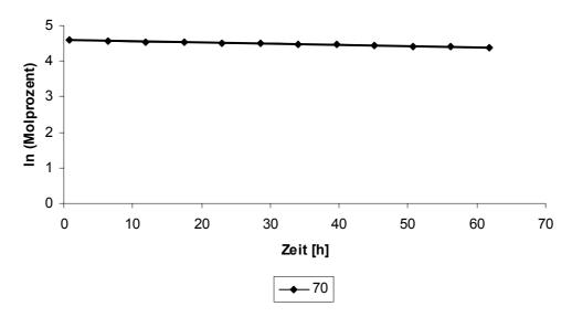
**Abb. 3.16:** Semilogarithmische Darstellung des Hydrolyseverlauf von **70** in H<sub>2</sub>O.
